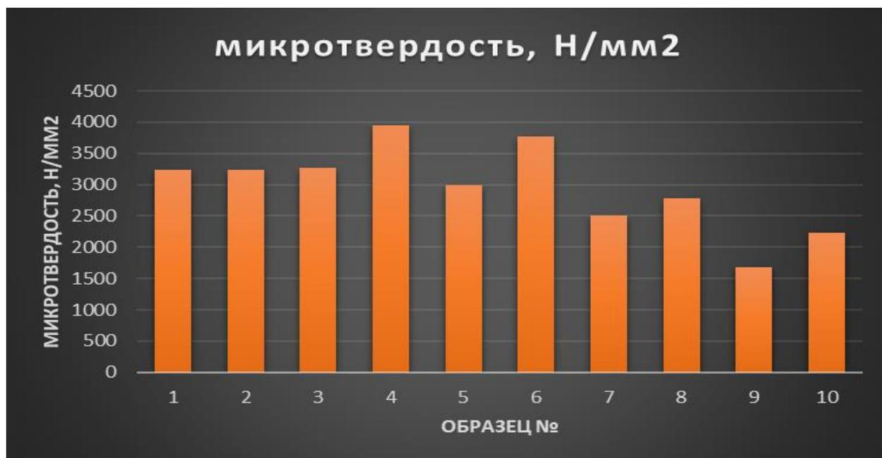
Диаграммы сравнения микротвердости, Н/мм<sup>2</sup> образцов, испытанных с разными присадками в масле, после 25 часов испытаний на машине трения 77МТ-1.
